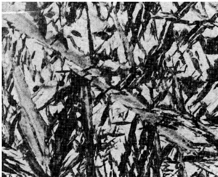
Fig. 1.1 Austenite residua ( chiara ) e martensite ( scura )
