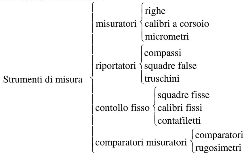
**STRUMENTI MISURATORI:** sono gli strumenti che portano una graduazione mediante la quale è possibile leggere il valore della grandezza misurata.
