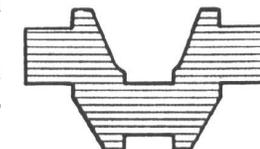
Quando è ottenuto per **fucinatura o stampaggio**, si ha una struttura fibrosa originaria deformata, in modo più o meno rilevante, a seconda delle entità delle deformazioni che ha subito il pezzo. Questa caratteristica struttura fibrosa induce nel materiale un notevole aumento della resistenza meccanica e della capacità di sopportare urti e sforzi ripetuti (**fatica**).
