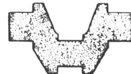
Quando è ottenuto per **asportazione di truciolo**, si ha una struttura fibrosa originaria, dovuta al processo di lavorazione che ha subito (laminazione, trafilatura), interrotta dal taglio del materiale in eccesso. *Le fibre sono una schematizzazione dei cristalli allungati nella direzione di laminazione o altra lavorazione tipica che produce lo stesso effetto.*
