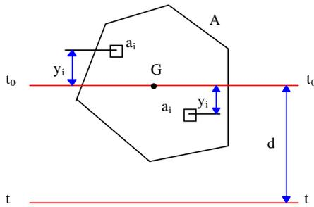
Le aree elementari  $a_i$  che stanno al di sopra dell'asse baricentrico  $t_0$ , distano  $(y_i + d)$  dall'asse  $t$ , mentre le aree elementari  $a_i$  che stanno al di sotto dell'asse baricentrico  $t_0$ , distano  $(y_i - d)$  dall'asse  $t$ . In generale possiamo scrivere:
