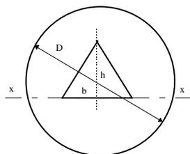
Si suddivide la figura in un cerchio e in un triangolo, si calcolano i momenti d'inerzia delle singole figure rispetto allo stesso asse e poi se ne calcola la differenza.
