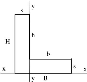
Si suddivide la figura nei due rettangoli ( $H \times s$ ) e ( $b \times s$ ), si calcolano i momenti d'inerzia dei singoli rettangoli rispetto allo stesso asse (asse passante per la base) e poi se ne calcola la somma.
