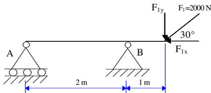
Si scompone la forza inclinata nelle sue due componenti perpendicolare e parallela all'asse della struttura:
