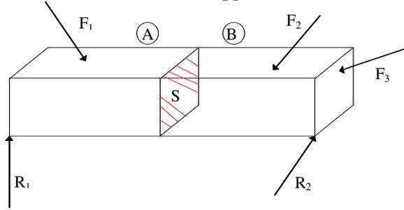
Immaginiamo di spezzare idealmente la struttura lungo la sezione S ottenendo i due tronchi A e B. Poiché la struttura nel complesso è in equilibrio, anche ogni sua parte lo deve essere; in particolare il tronco A da solo sarà in equilibrio se aggiungiamo le azioni che, lungo la sezione S, il tronco B trasmette al tronco A. Tali azioni sono proprio le caratteristiche della sollecitazione che nel caso spaziale sono 6 (3 forze + 3 momenti):
