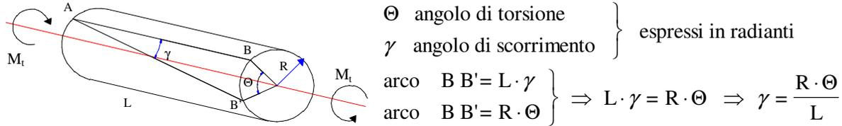
TENSIONI: dovendo opporsi a deformazioni di scorrimento, giacciono sul piano della sezione, quindi sono delle tensioni tangenziali  $\tau$  e poiché le deformazioni crescono dal centro alla periferia, le tensioni saranno massima lungo il bordo della sezione e nulle sul centro della sezione.
