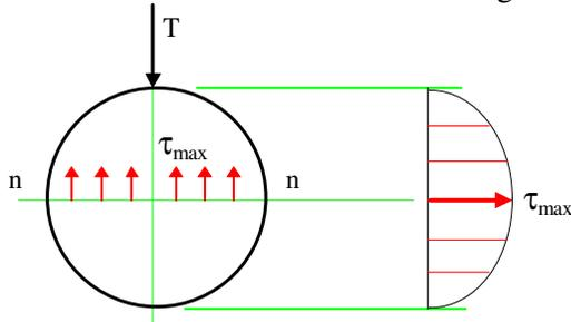
$$\tau_{\max} = \frac{4 T}{3 A} \quad \left\{ \begin{array}{l} T \text{ sforzo di taglio nella sezione (N)} \\ A \text{ area della sezione resistente (mm}^2\text{)} \end{array} \right.$$
