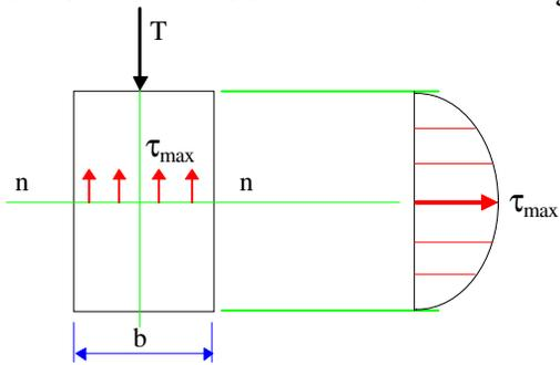
$$\tau_{\max} = \frac{3 T}{2 A} \quad \left\{ \begin{array}{l} T \text{ sforzo di taglio nella sezione (N)} \\ A \text{ area della sezione resistente (mm}^2\text{)} \end{array} \right.$$
