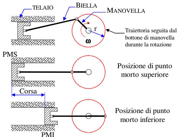
Facendo ruotare la manovella, lo stantuffo si muoverà con velocità variabile, lungo una traiettoria rettilinea, tra due punti estremi chiamati PUNTO MORTO SUPERIORE (PMS) e PUNTO MORTO INFERIORE (PMI). Questi punti sono chiamati morti, perché in questi punti è nulla la velocità dello stantuffo.
