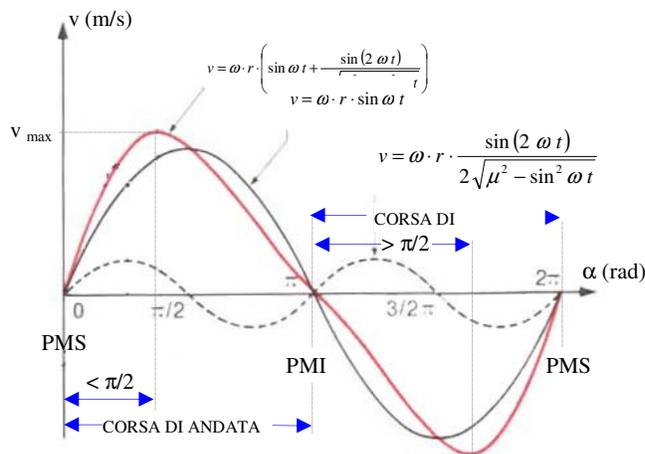
Ogni valore della velocità è composto da due termini, le cui rappresentazioni grafiche sono riportate nel DIAGRAMMA DELLA VELOCITÀ in FUNZIONE DELL'ANGOLO DI MANOVELLA. Sommando punto per punto i valori delle ordinate dei due grafici si ottiene il valore istantaneo della velocità del piede di biella.
